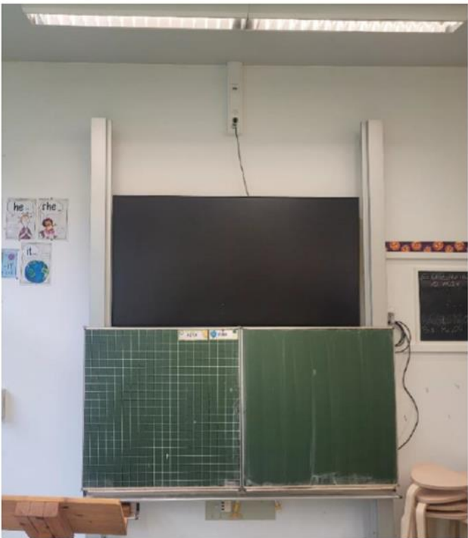
Abbildung 4 75 Zoll Display integriert in vorhandenes Tafelsystem
