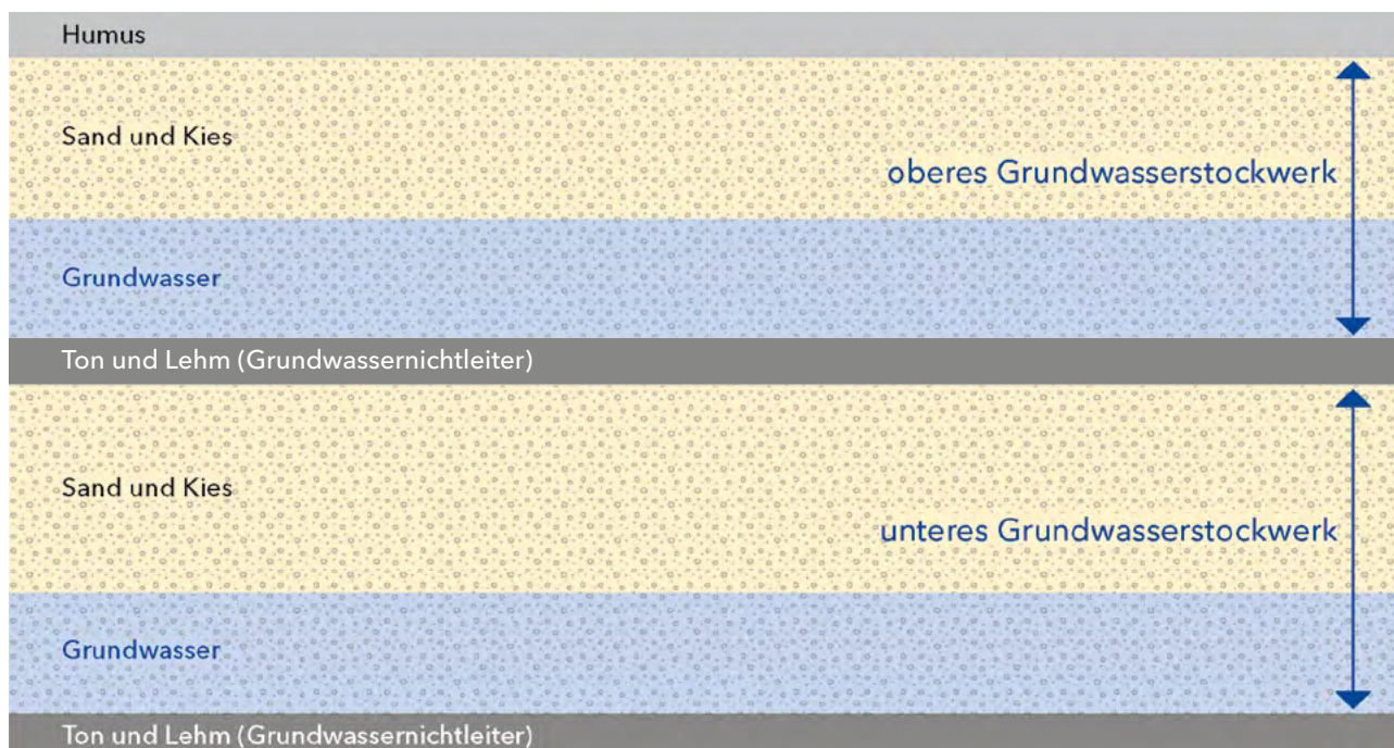
Abb. 7: Schematische Darstellung eines Grundwasserstockwerksbaus.
